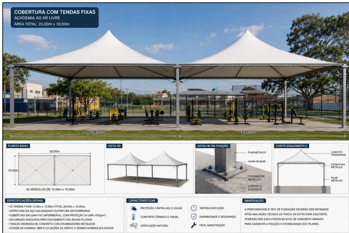
Figura 01 – Estrutura da cobertura em lona utilizada como elemento de proteção, evidenciando o sistema de sustentação e ancoragem.
